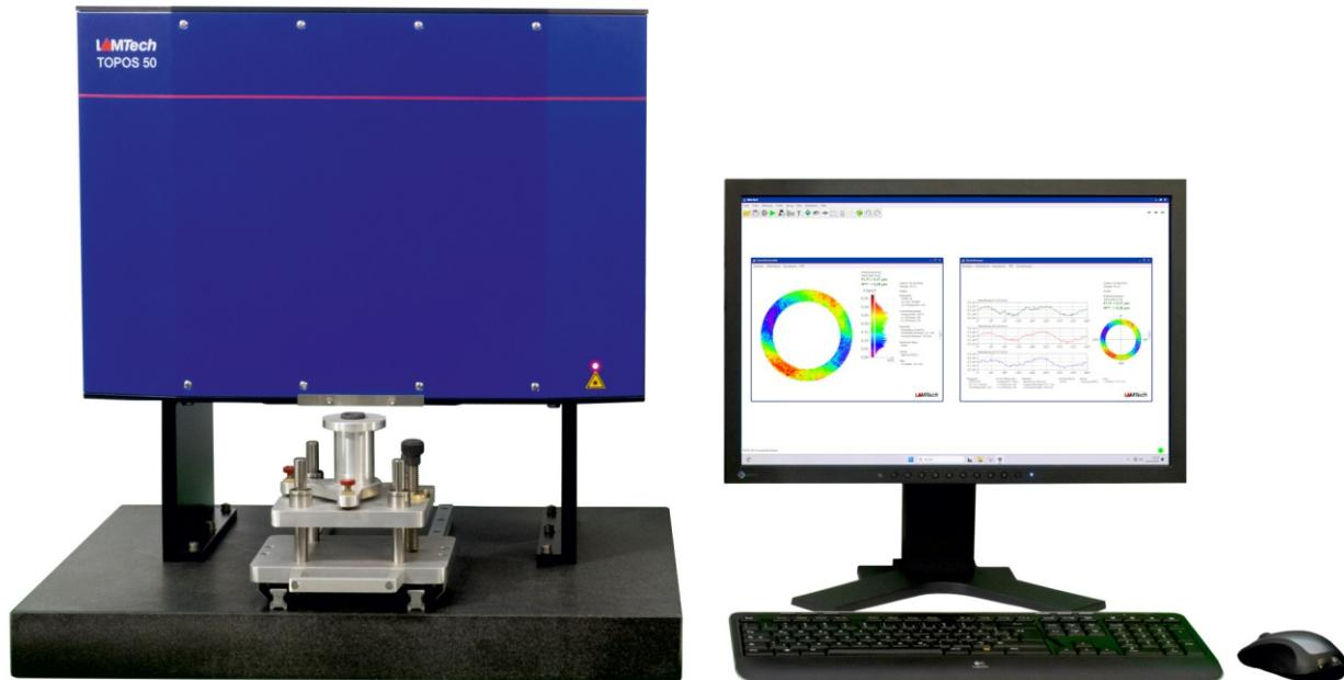
Das TOPOS 50 ist ein berührungslos arbeitendes Messgerät zur Bestimmung der Ebenheit feinbearbeiteter Oberflächen im  $\mu\text{m}$ -Bereich.
