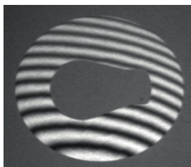
Interferogram einer \text{Al}_2\text{O}_3 - Regelscheibe, die als Bitmap im Intdok abgespeichert werden kann
